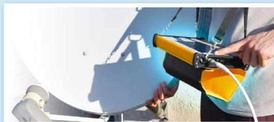
**HD RANGER UltraLite** является универсальным анализатором, который охватывает огромный спектр стандартов вещания по всему миру. Новейшие разработки в вещательных технологиях, такие как DVB-T/T2, DVB-C/C2, DVB-S/S2 с видео MPEG-2 и MPEG-4, включенные в этом измерительном приборе.
