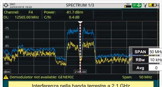
Interferenza nella banda terrestre a 2,1 GHz causata da una stazione per la telefonia mobile
