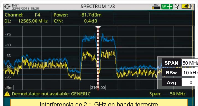
Interferencia de 2,1 GHz en banda terrestre desde una estación de telefonía móvil
