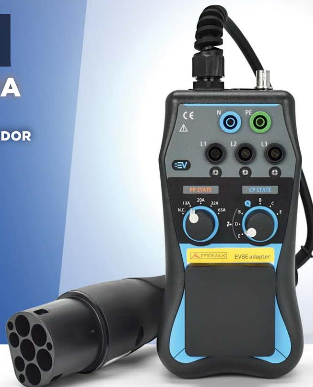
El adaptador **IC-610** permite llevar a cabo la comprobación de las estaciones de carga de vehículos eléctricos utilizando comprobadores de instalaciones eléctricas compatibles como el **IC-600**. Por un lado se conecta a la estación de carga a través de un conector Tipo-2 y por el otro extremo se conecta al comprobador de instalaciones.
