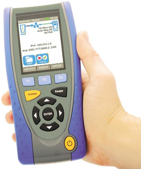
El **IC-075D** es un cualificador de cables y redes portátil, diseñado para confirmar la instalación correcta de cableado de fibra óptica y cobre con capacidad de transportar voz, vídeo, datos y aplicaciones CCTV por Ethernet de 10/100 Megabit o Gigabit.
