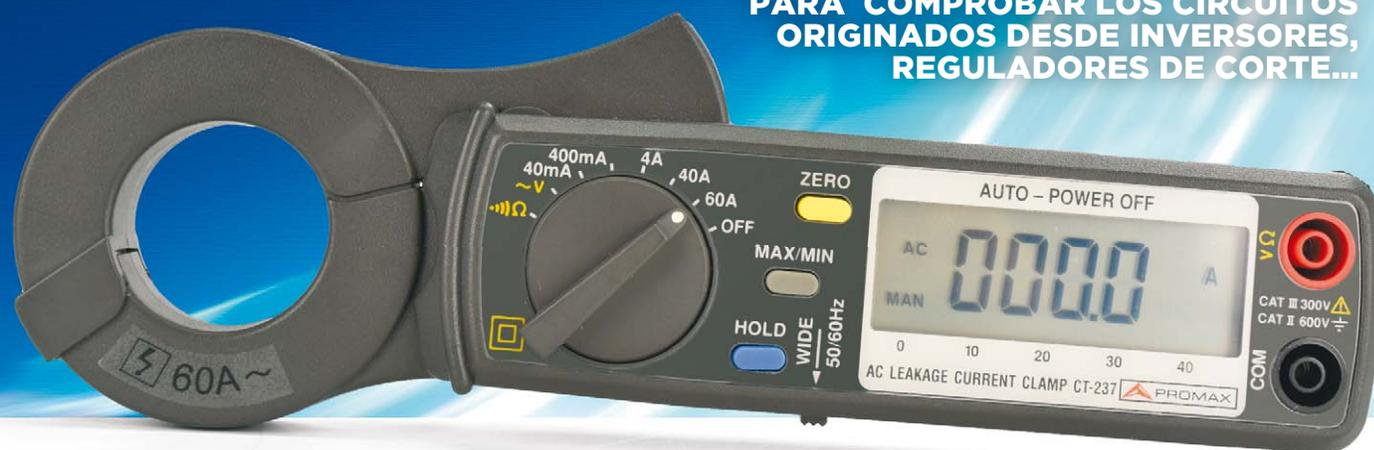
El **CT-237** es un medidor de pinza digital AC de precisión para la medición de corrientes de fuga que incluye selección de modo de funcionamiento en baja frecuencia (50/60 Hz) o en alta frecuencia (hasta 1 kHz). Tanto en modo numérico como en forma de **barra gráfica de 20 muestras por segundo**. Incorpora un circuito de filtrado diseñado para eliminar el efecto del ruido parásito de alta frecuencia y de los armónicos para la medición de corriente AC.
