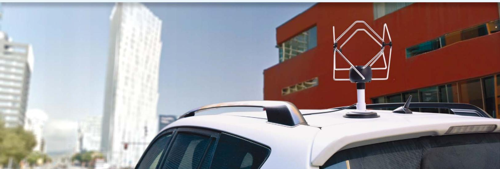
**AM-060****ANTENA OMNIDIRECCIONAL PORTÁTIL
