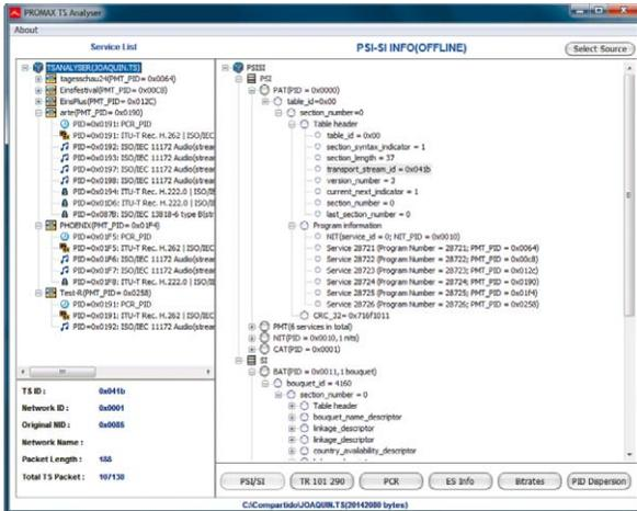
**TS ANALYSER** es una aplicación de software gratuita que permite el análisis de bajo nivel de los transport stream (flujos de transporte) MPEG-2 de televisión digital DVB.
