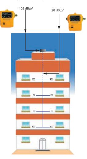
6 ECUALIZACIÓN DE LA BANDA de FI de satélite. Genera tres señales en la banda de satélite. Con un analizador de espectros, se puede realizar el ajuste de la pendiente muy fácilmente. Además también genera una señal en banda UHF.
