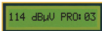
El acceso por Canales depende del plan de canales elegido. La sintonía por Programas facilita el acceso directo hasta 64 canales. El número de programas puede ser limitado para adaptar los ciclos de medida a la capacidad de la red.
