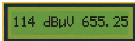
de cualquier frecuencia entre 45 y 862 MHz con una resolución de 62,5kHz.
