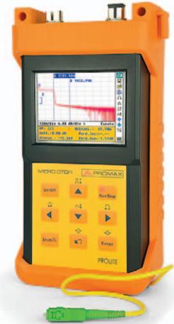
Los reflectómetros ópticos **PROLITE-50/51/52** permiten caracterizar una línea de fibra óptica. Al trabajar por reflexión, analizan todos los eventos de la fibra (conectores, empalmes, fusiones, splitters, etc.) haciendo que sean herramientas muy útiles para los trabajos de mantenimiento y reparación.
