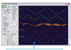
El osciloscopio virtual integrado de 1 a 8 entradas contiene todas las funcionalidades de un osciloscopio real. Las señales a visualizar son marcadas mediante sondas.
