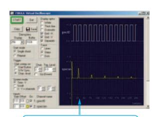
Análisis espectral, descomposición en serie de Fourier de una señal cuadrada.
