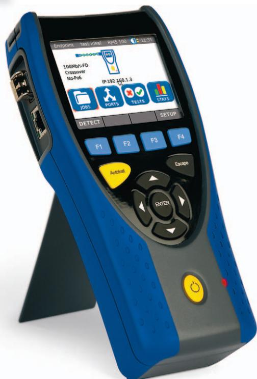
El **IC-082** es un medidor de redes activas o pasivas para detectar fallos de conectividad en cables de cobre y fibra, así como en redes Wi-Fi. Realiza comprobaciones de fallos en el funcionamiento de las redes, comprobaciones de accesibilidad, estadísticas de tráfico, mapeados de la red, mediciones de PoE, VoIP y más.
