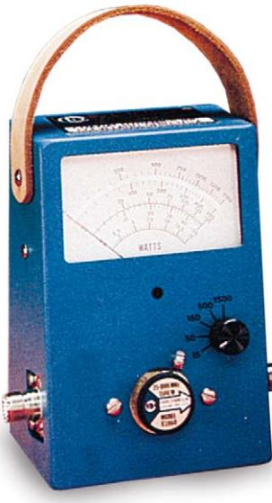
El vatímetro direccional modelo **IC-002** (81050) es un preciso medidor de potencia de RF portátil que utiliza un Elemento Detector Rotativo para medir la Potencia Directa y Reflejada en 5 márgenes de potencia seleccionables. El modelo 81050 incluye conectores de tipo "Quick Match" para su mayor versatilidad. El equipo se entrega en una maleta de transporte con alojamiento para cargas y conectores.
