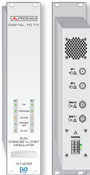
Los módulos **DT-232** son transmoduladores dobles de DVB-S/S2 (QPSK/8PSK) a DVB-T (COFDM). Sus entradas QPSK/8PSK pueden sintonizarse a cualquier transpondedor de satélite siendo su salida en banda UHF.
