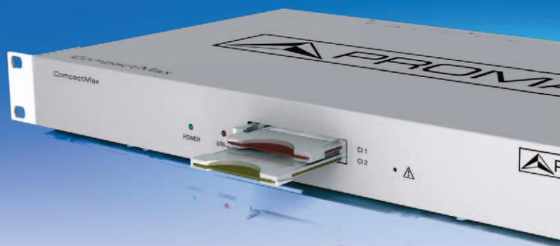
**CompactMax-4** es un sistema compacto que permite distribuir canales de TV Satélite (DVB-S o DVB-S2) en el formato de la Televisión Digital Terrestre (ISDB-T/TB).
