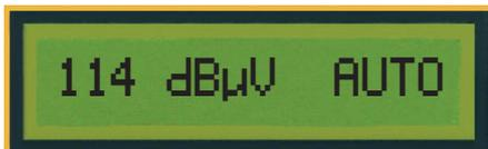
In Situationen, bei denen ein bestimmter Wert für den Abschwächer verwendet werden soll, kann die manuelle Abschwächerwahl benutzt werden. Die Messwert werden in dBµV oder dBmV angezeigt.
