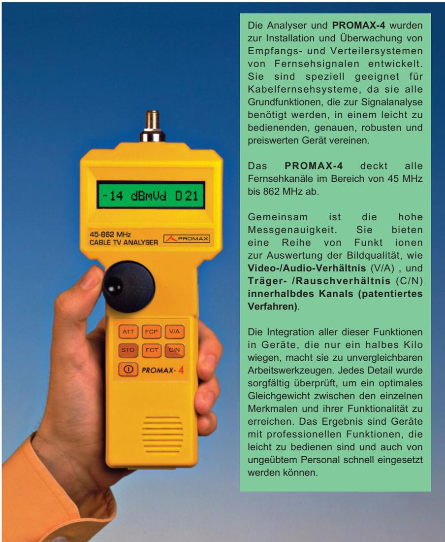
Die Analyser und **PROMAX-4** wurden zur Installation und Überwachung von Empfangs- und Verteilersystemen von Fernsehsignalen entwickelt. Sie sind speziell geeignet für Kabelfernsehsysteme, da sie alle Grundfunktionen, die zur Signalanalyse benötigt werden, in einem leicht zu bedienenden, genauen, robusten und preiswerten Gerät vereinen.
