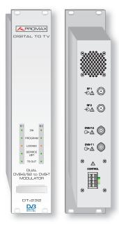
Das Modul **DT-232** ist ein dualer DVB-S/S2 (QPSK/8PSK) zu DVB-T (COFDM) Transmodulator. Die QPSK/8PSK Eingänge empfangen einen beliebigen Satellitentransponder und stellen die gewünschten Inhalte am Ausgang im UHF-Band zur Verfügung.
