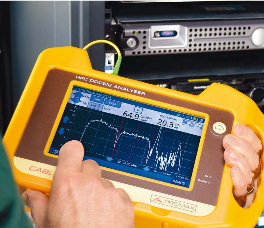
El **CABLE RANGER** es un analizador para la instalación, configuración y mantenimiento de servicios interactivos de vídeo y datos a alta velocidad sobre redes de TV basadas en los estándares DOCSIS 3.0 y EuroDOCSIS. Permite la cualificación de servicios VoIP e IPTV.
