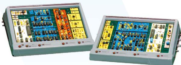
El entrenador **EC-796** está compuesto por dos módulos, uno emisor y otro receptor. Incorpora diferentes tipos de emisores, moduladores, canales de transmisión, demoduladores y receptores para configurar diversos tipos de sistemas de transmisión digitales.
