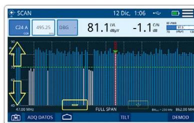
Función SCAN: Todos los canales en pantalla junto a sus niveles de señal.
