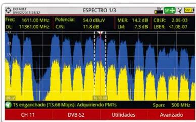
Analizador de espectro ultra rápido profesional con filtros de hasta 2 kHz
