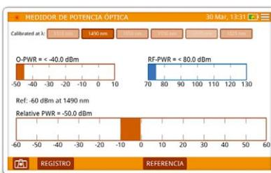
Medidor de potencia óptica incorporado.
