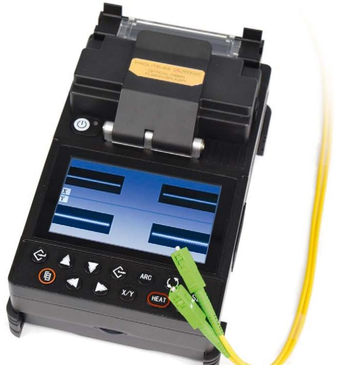
La fusionadora extraplana **PROLITE-42** con **batería reemplazable** responde a las mayores exigencias de calidad. Es el diseño perfecto para la instalación y mantenimiento de toda clase de redes de fibra óptica, en especial para los instaladores de FTTH.
