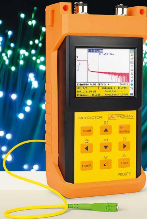
Permiten caracterizar una línea de fibra óptica. Al trabajar por reflexión, analizan todos los eventos de la fibra (conectores, empalmes, fusiones, splitters, etc) haciendo que sean herramientas muy útiles para los trabajos de mantenimiento y reparación.
