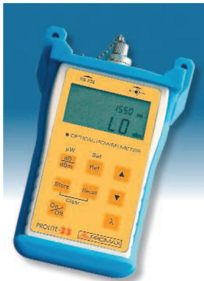
hinaus verfügt das **PROLITE-23** über einen Speicher für 3200 Messungen. Die Messdaten können zum Ausdrucken oder für weitere Bearbeitung an einen PC übertragen werden
