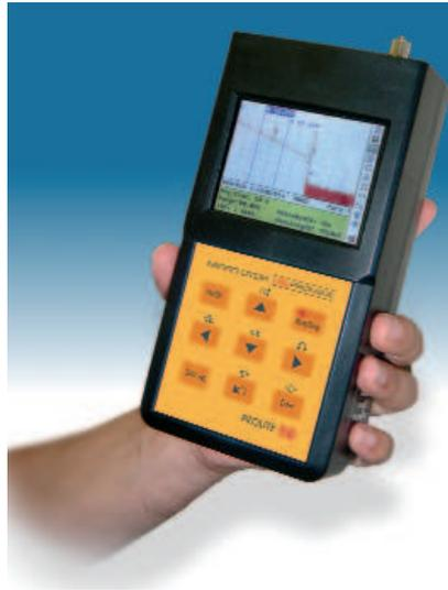
Darüber hinaus können die Messkurven abgespeichert und mit Hilfe der mitgelieferten Software an einen PC übertragen und dann weiter bearbeitet, analysiert oder ausgedruckt werden.
