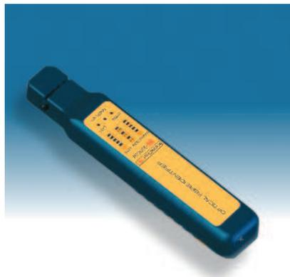
wandfrei erkennen. Es eignet sich zur Prüfung der verschiedensten Kabel, auch 250 µm und 900 µm sowie geschirmte 2mm und 3mm Kabel.
