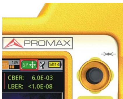
Figura 35. Joystick con función SPAN (selección por canal)
