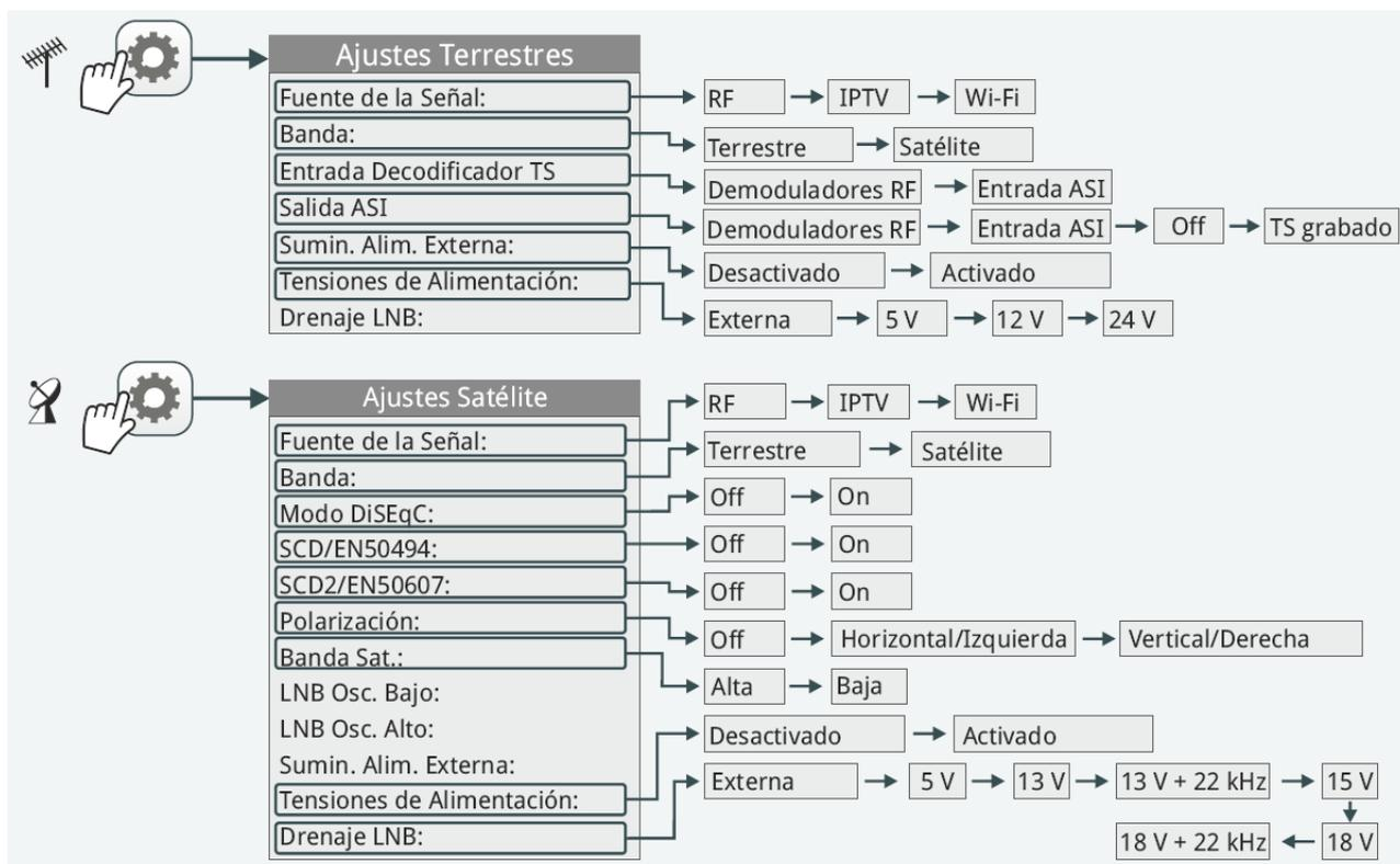
Figura 45. Ajustes para señal RF (banda terrestre y satélite)
