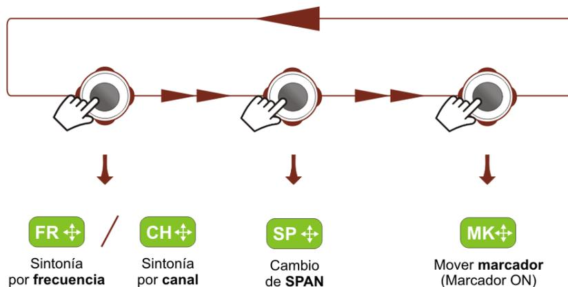
**Figura 40. Funciones del Joystick en modo ANALIZADOR DE ESPECTROS.**
