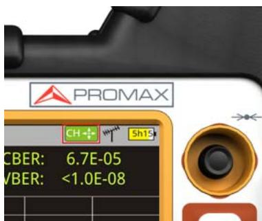
**Figura 41. Joystick con función CH (selección por canal)**
