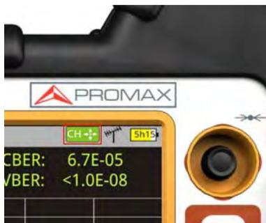
**Figura 24. Joystick con función CH (selección por canal)**
