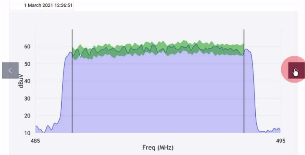
**Figura 147. Gráfica de Espectro de Monitorización (detección por Desviación)**
