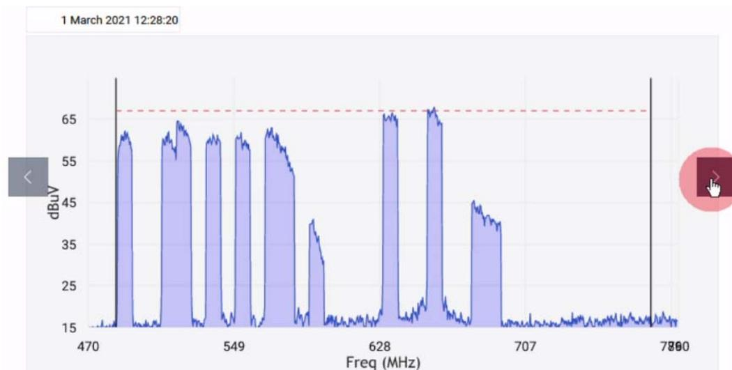
Figura 146. Gráfica de Espectro de Monitorización (detección por Max/Min)
