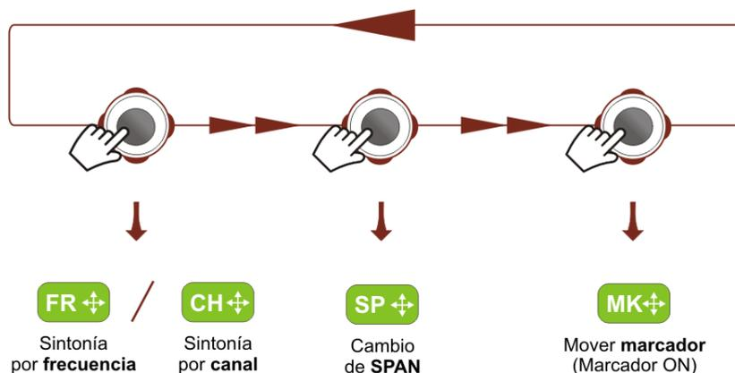
**Figura 25. Funciones del Joystick en modo ANALIZADOR DE ESPECTROS.**
