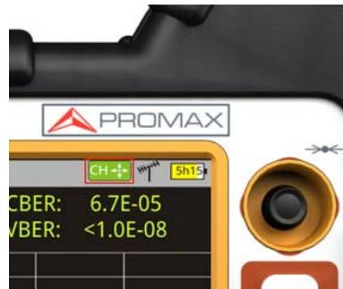
**Figura 26. Joystick con función CH (selección por canal)**
