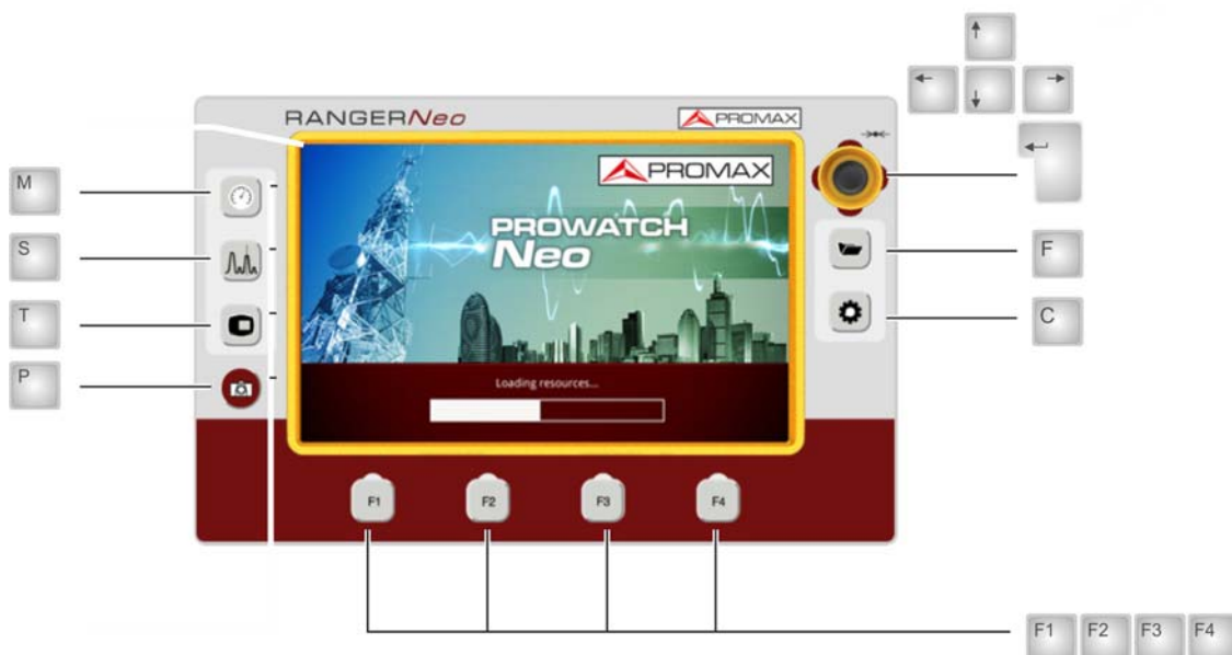
Figura 8. Equivalencia entre Teclado y consola del equipo Portátil
