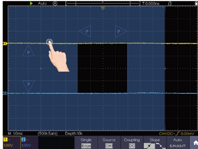
Cuando aparece el icono "P" en pantalla completa, deslice el dedo hacia la izquierda / derecha para controlar la posición horizontal y deslice el dedo hacia arriba/abajo para controlar la posición vertical del canal seleccionado.
