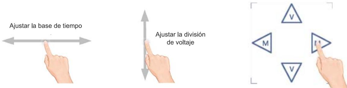
En pantalla completa, pellizque y separe los dedos horizontalmente para cambiar la base de tiempo y pellizque y separe los dedos verticalmente para cambiar la división de voltaje del canal seleccionado.
