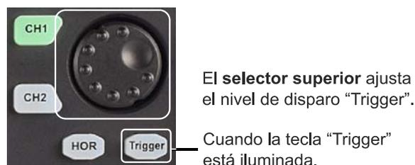
Figura 3-12 Zona de control del Trigger
