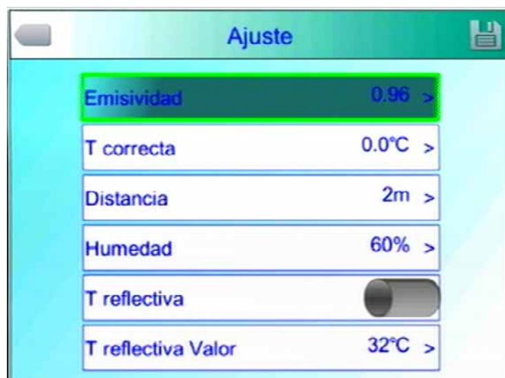
Menú corrección de medición de temperatura
