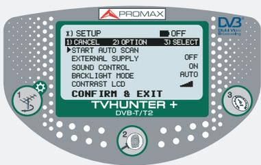
En la pantalla de **DETECCIÓN**, mantenga pulsado hasta que aparezca el menú de configuración.
