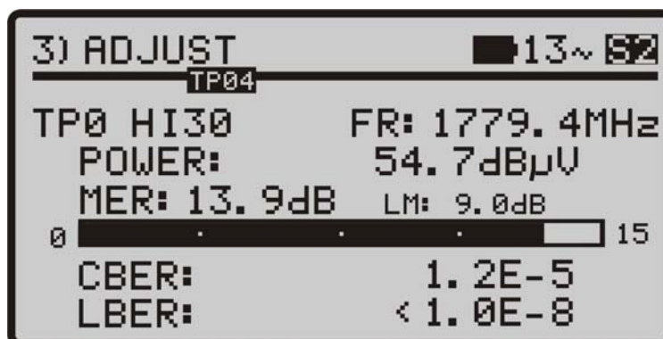
Figura 15.- Pantalla de medida de DVB-S2 con LBER .
