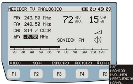
**Figura 32.-** Medición de la señal de audio analógico.
