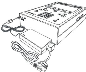
Figura 2.- Adaptador de red conectado al **PROLITE-77B**.
