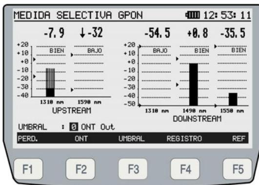
Figura 7.- Pantalla inicial **MEDIDOR GPON**.
