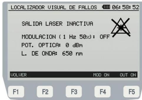
Figura 26.- Pantalla del módulo **LOCALIZADOR DE FALLOS** (inactivo).
