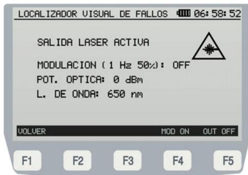
**Figura 27.-** Pantalla del módulo **LOCALIZADOR DE FALLOS** (activo).
