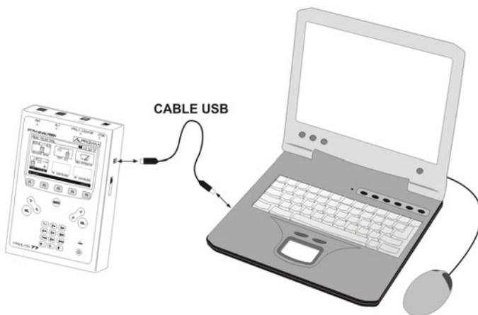
Figura 32.- Conexión entre el **PROLITE-77B** y el PC.
