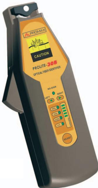
El identificador de fibra óptica **PROLITE-30B** es un instrumento con una excelente relación calidad-precio, portátil y diseñado para identificar señales ópticas y tráfico de datos en tiempo real sin necesidad de interrumpir el sistema. Simplemente sujetando la fibra con el **PROLITE-30B** el instrumento indicará si hay señal o tráfico y mostrará la dirección de la señal. Puede detectar una variedad de frecuencias ópticas: 270 Hz, 1 kHz y 2 kHz.
