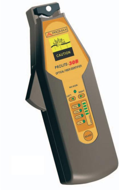
El identificador de fibra óptica **PROLITE-30B** es un instrumento con una excelente relación calidad-precio, portátil y diseñado para identificar señales ópticas y tráfico de datos en tiempo real sin necesidad de interrumpir el sistema. Simplemente sujetando la fibra con el **PROLITE-30B** el instrumento indicará si hay señal o tráfico y mostrará la dirección de la señal. Puede detectar una variedad de frecuencias ópticas: 270 Hz, 1 kHz y 2 kHz.
