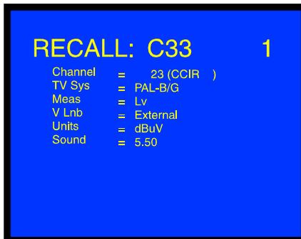
Figura 22 .- Pantalla RECALL, recuperación de una configuración de medida.
