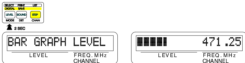
Figura 10.- Selección del modo de lectura de nivel mediante barra gráfica.
