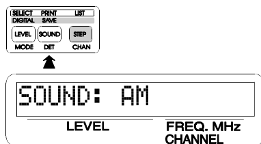
Figura 26.- Demodulación de sonido AM.
