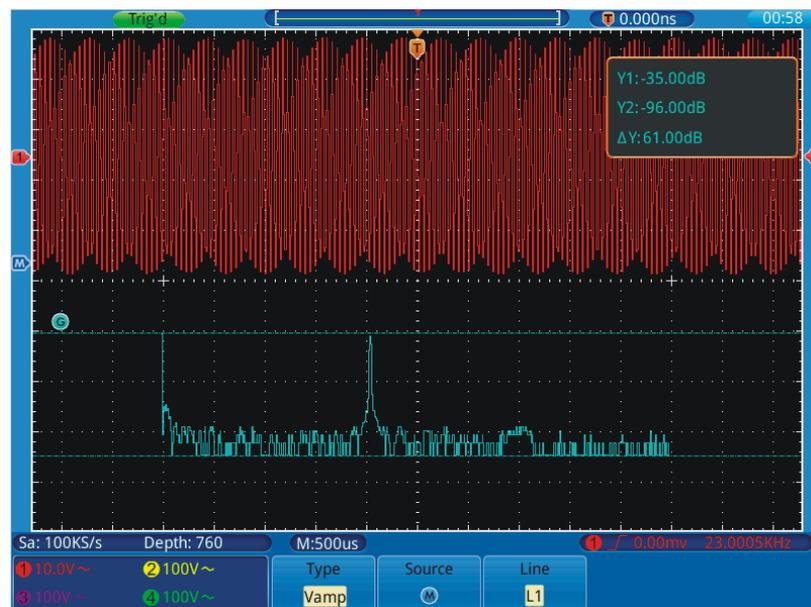
**Figura 34.** Medición con cursor de la forma de onda del Vamp.
