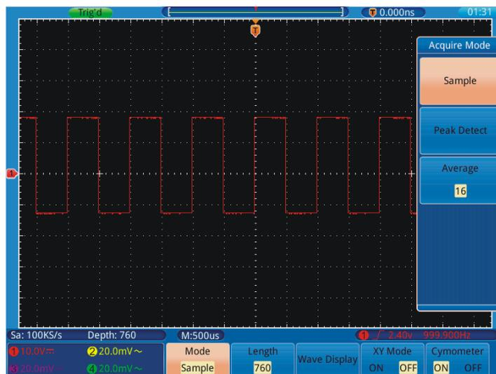
**Figura 24.** Modo de Adquisición normal, no existen residuos.
