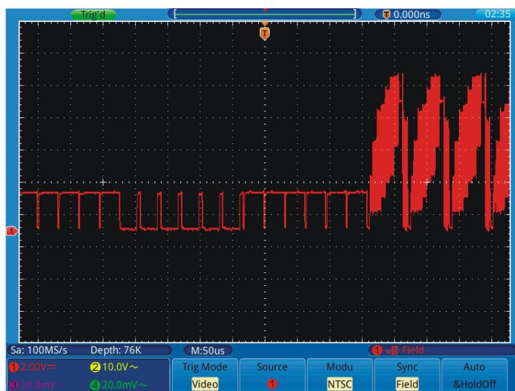
Figura 50. Forma de Onda captura usando el trigger de vídeo – campo.
