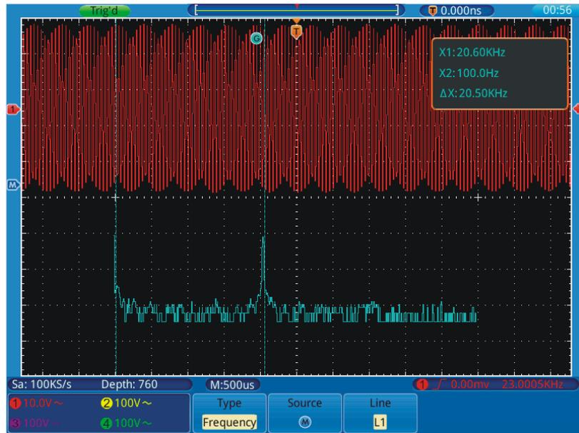
**Figura 35.** Medición con cursor de la forma de onda de la frecuencia.
