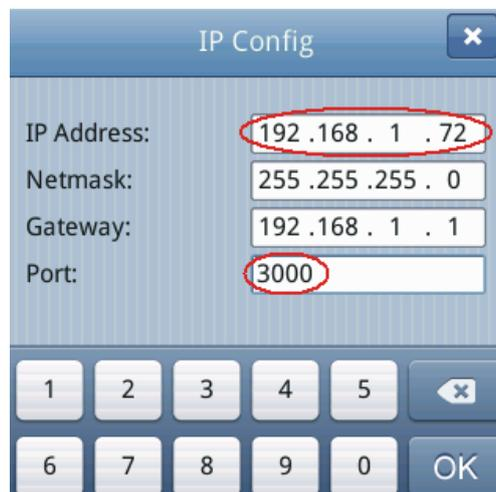
**Figura 40.** Ajuste de los parámetros de red del Osciloscopio.
