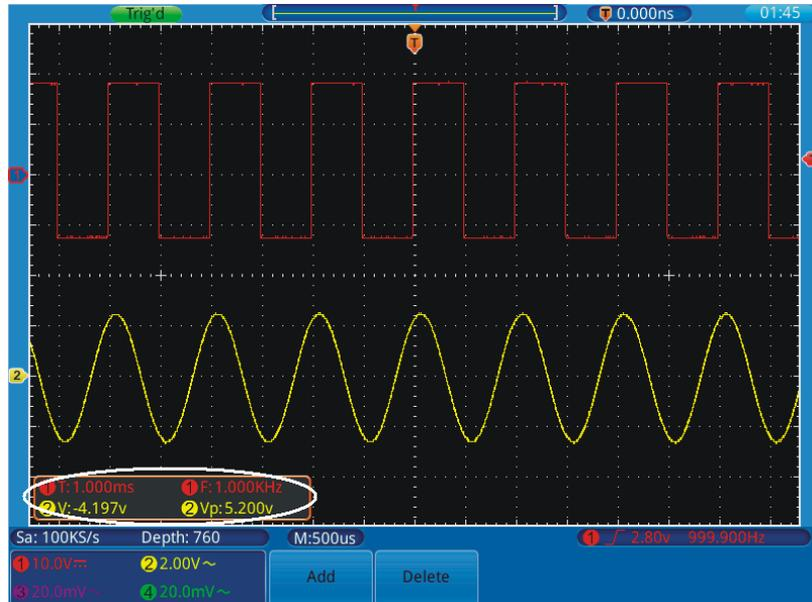
**Figura 44.** Medida de Frecuencia y Vpp para una señal.
