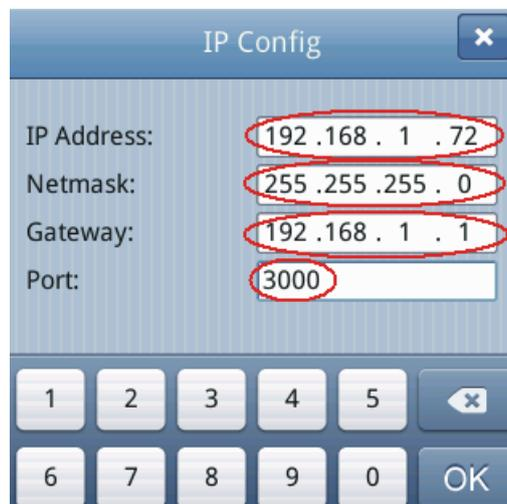
**Figure 43** Ajuste de los parámetros de red del Osciloscopio.
