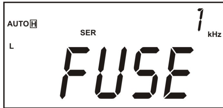
Figura 6.- Detección del estado del fusible.
