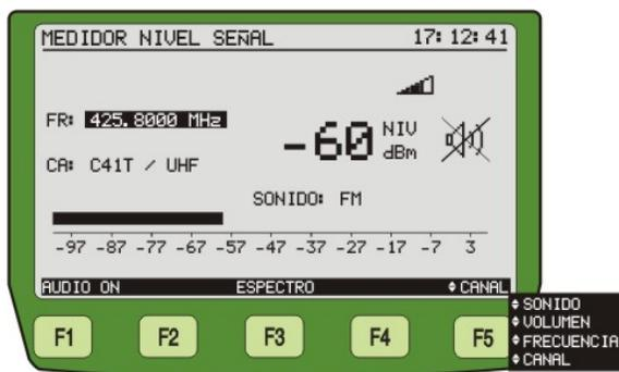
**Figura 11.-** Pantalla de **MEDIDA DEL NIVEL DE SEÑAL**.
