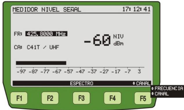
Figura 14.- Pantalla de **MEDIDA DEL NIVEL DE SEÑAL**.
