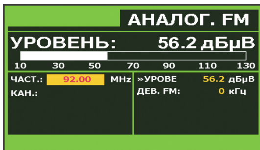
Рис. 25.- Измерение уровня сигнала Аналоговый FM.
