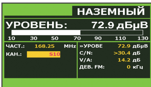
Рис. 22.- Измерение уровня аналогового сигнала в наземном диапазоне частот.
