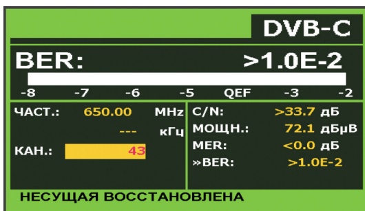
Рис. 29.- Экран измерения BER для сигналов QAM .
