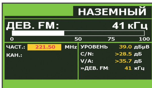
Рис. 24.- Измерение мгновенного отклонения частоты.
