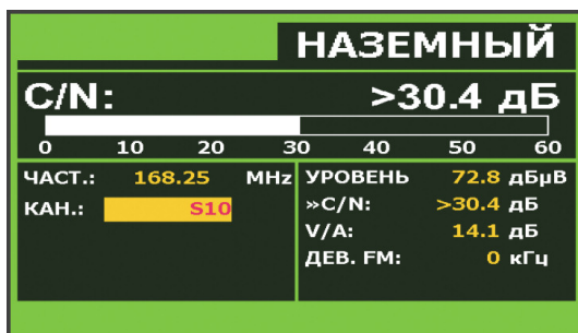
Рис. 26.- Измерение соотношения Несущая-Шум (C/N).
