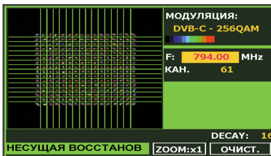
Рис. 42.- Конституционная Диаграмма. Сигнал DVB-C (QAM 256).
