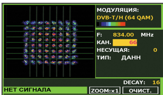
Рис. 40.- Констелляционная Диаграмма. Сигнал DVB-T/H (QAM 64).
