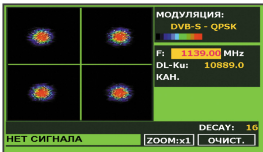
Рис. 43.- Конstellяционная диаграмма. Сигнал DVB-S (QPSK).
