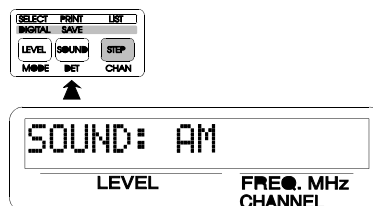
Рис. 26.- Демодулятор АМ звуку.
