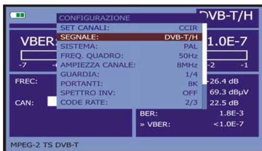
Figura 20.- Schermata di configurazione di misura di segnali modulate in COFDM.
