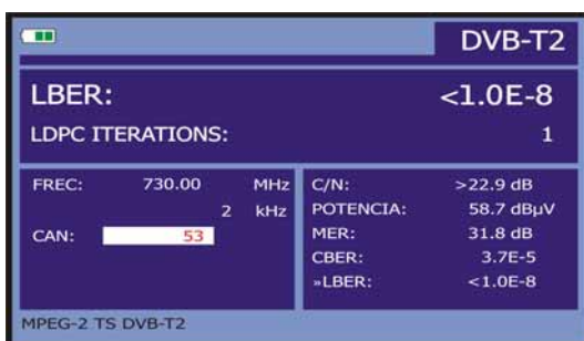
Figura 37.- Visualizzazione della misura LBER segnali modulati COFDM. (DVB-T2).
