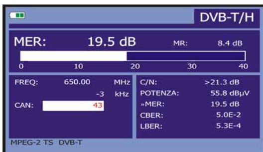
Figura 43.- Schermata di misura del MER per segnalare DVB-T/H modulata in COFDM.
