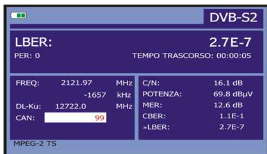
Figura 42.- Schermata di misura del LBER di segnali modulati in QPSK/8PSK. (DVB-S2).
