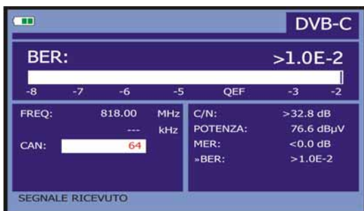
Figura 30.- Schermo di misura del BER di segnali modulati in QAM .
