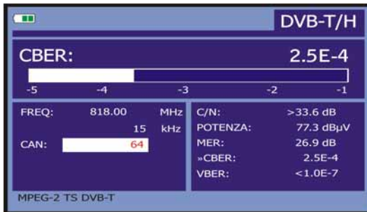
Figura 32.- Schermata di misura del CBER di segnali modulate in COFDM.
