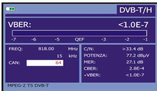
Figura 34.- Schermo di misura del VBER di segnali modulate in COFDM. VBER.
