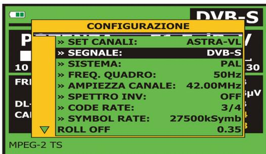
Figura 21.- Schermata di configurazione per la misurazione di segnali modulati in **QPSK**.
