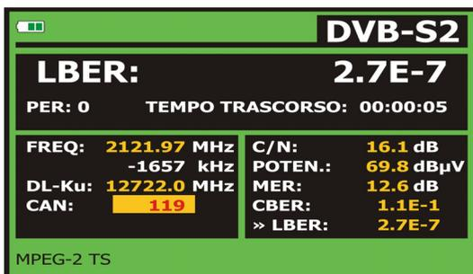
Figura 38.- Schemata di misurazione LBER di segnali DVB-S2 (QPSK/8PSK).
