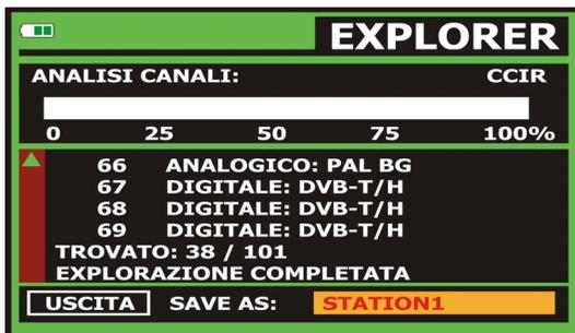
Figura 18.- Schermata di esplorazione dello spettro. **EXPLORER**.
