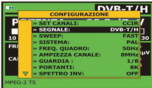
Figura 20.- Schermata di configurazione per la misurazione di segnali modulati in COFDM.
