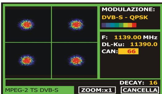
Figura 44.- Diagramma a costellazione. Segnale DVB-S (QPSK).
