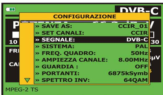
Figura 19.- Schermata di misurazione di segnali modulati in QAM.
