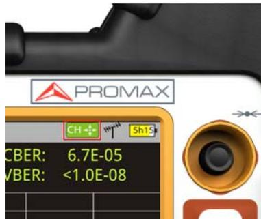
**Figure 41. Joystick avec fonction CH (syntonisation par canal)**
