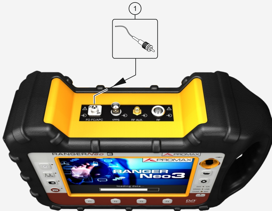
① Connecteur FC-APC (entrée du signal optique)
