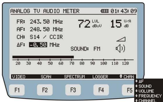
Figure 32.- Mesureur du signal d'audio analogique.
