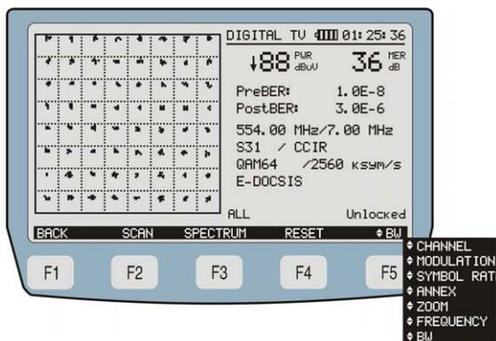
Figure 25.- Diagramme de constellation et mesures d'un canal numérique.
