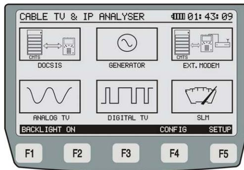
Figure 3.- Écran initial avec les touches programmables **SOFTKEYS**.
