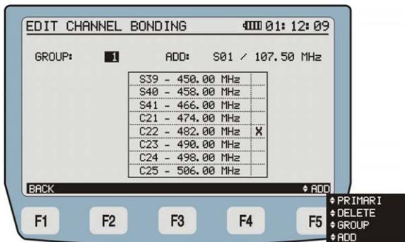
Figure. 9.- Edition d'un groupe *Channel Bonding*.
