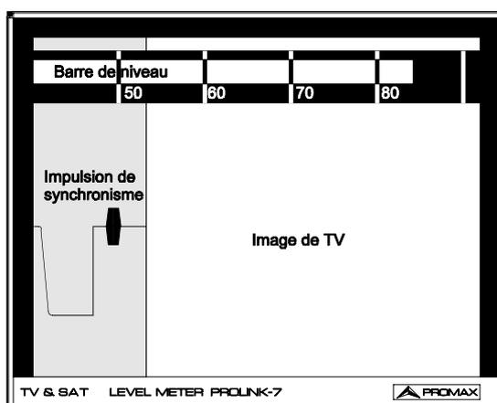
Figure 9.- Synchronisme de ligne + niveau + télévision
