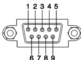
Figure 25.- PROLINK-7 connecteur RS-232C. Numération des pins.
