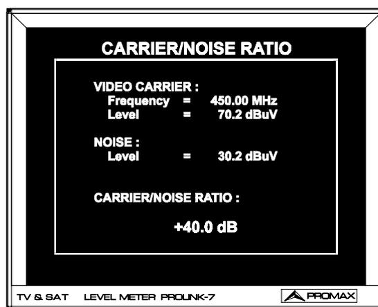
Figure 6.- Mode de mesure du rapport CARRIER/NOISE
