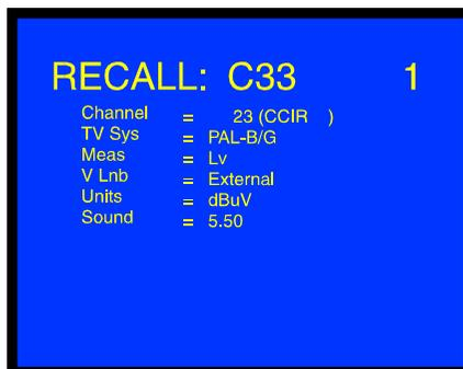
Figure 22 .- Écran RECALL, récupération d'une configuration de mesure.
