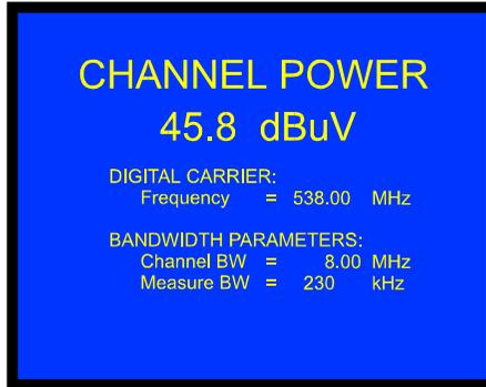
**Figure 10.-** Mesure de puissance des canaux numériques.
