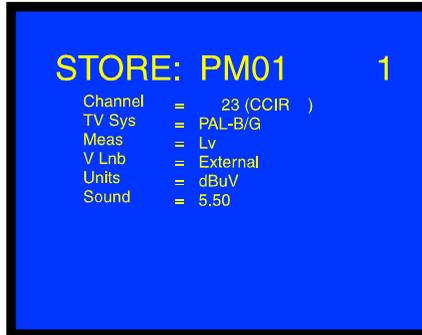
Figure 21 .- Écran STORE, emmagasinage d'une configuration de mesure.
