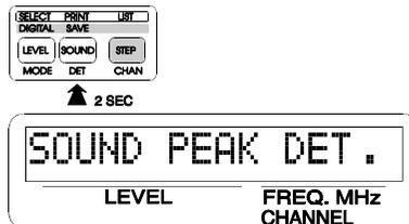
Figure 28.- Mesure en mode Détection de Crête
