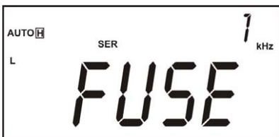
Figure 6.- Détection de l'état du fusible.
