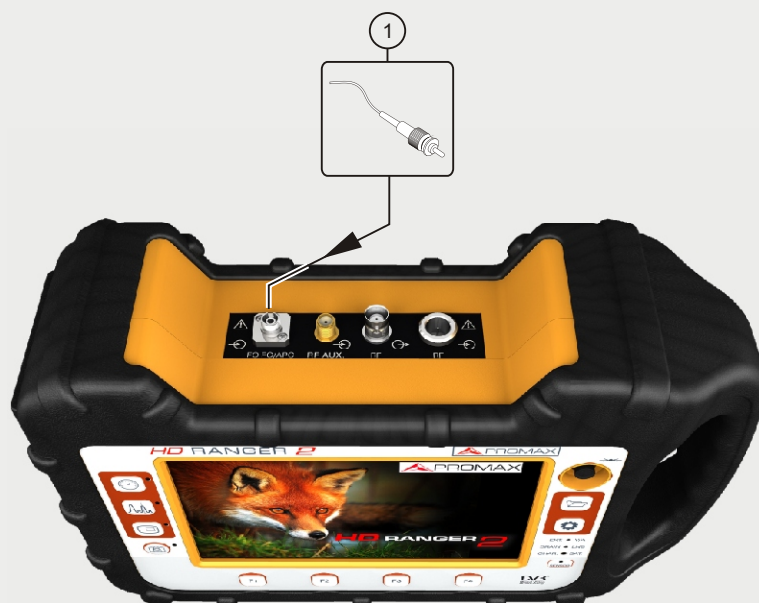
① Connecteur FC-APC (entrée du signal optique)
